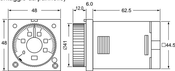
Modello con terminale a Pin (Montaggio superficiale)
